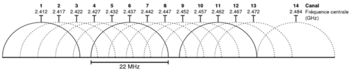
On remarque ici que les canaux se chevauchent entre eux. C'est pour cela qu'il est recommandé d'utiliser le canal 1, 6 et 11 pour éviter ce chevauchement.
